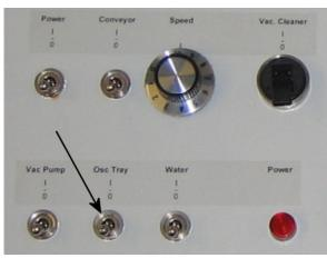
Accione el interruptor de potencia principal que está en la parte superior de la caja de control y luego el interruptor
