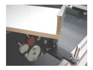
Cuidadosamente inspeccione la tela de cobertura en los bordes de la tolva de semillas para observar si hay daño. No utilice la tolva bajo ninguna circunstancia si falta la tela o esta dañada, puede hacer daño irreparable al cilindro. Lave la tolva de semillas con agua tibia, agua jabonosa y un trapo suave. No use solventes de ninguna forma, porque pueden disolver el adhesivo de la parte trasera de la tela.
