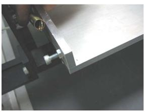
Remueva los resortes de cada lado desenganchándolos de los tornillos. Los resortes quedaran en su lugar en la parte interior del los postes de montaje
